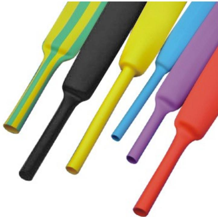
Guaina termorestringente di alta qualità a doppia parete con collante interno. Il **CIERREFLUX COLOR** non contiene pvc al suo interno, ha una restringimento di 4:1, ed è la soluzione ideale per protezione di giunture sottoposte ad umidità, immersione o sotterrate.
