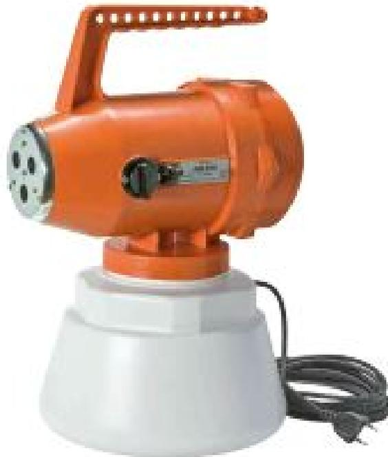
**FOG 001** è un generatore di nebbia elettrico compatto e maneggevole per l'applicazione di liquidi concentrati o pronti all'uso in ambienti domestici, civili ed industriali. La struttura è in materiale termoplastico resistente agli urti e il serbatoio contiene circa 5 Litri di prodotto. Lo strumento ha una gittata di 5-7 m ed è in grado di saturare a freddo e in pochi minuti ampie cubature (circa 800 m<sup>3</sup> con una sola ricarica di 5 L).
