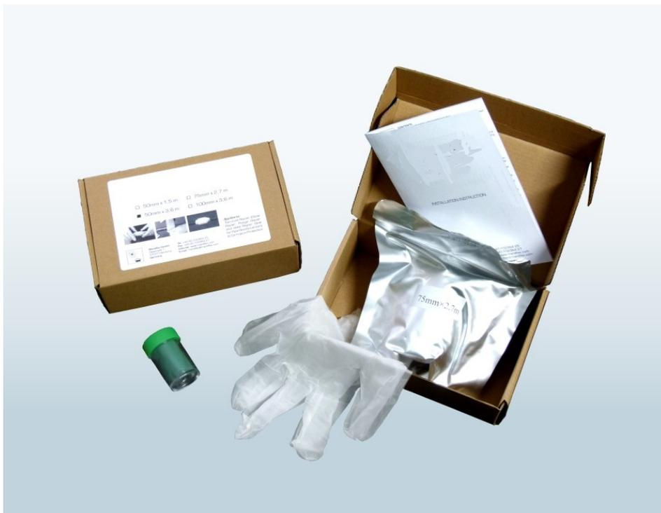
Il **CR MF40** è una soluzione altamente professionale, facile da usare per riparare in emergenza perdite su tubi. Ogni kit comprende una benda imbevuta di resina idroattivante ( che si attiva e indurisce dopo il contatto con l'acqua) uno stick di mastice bicomponente, facilmente amalgamabile a mano, per la chiusura della fessura e un paio di guanti per un utilizzo sicuro e pulito del kit.
