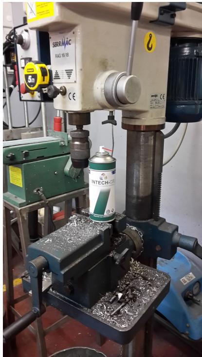
Fluido da taglio universale. La qualità dell'olio di sintesi contenuto, permette l'utilizzo del FREECUT sia per lavori di foratura ma soprattutto maschiatura e filettatura. perfetto su acciaio inox ad alto tenore di cromo, nichel, manganese, titanio, acciai normali e teneri, bronzi ecc.
