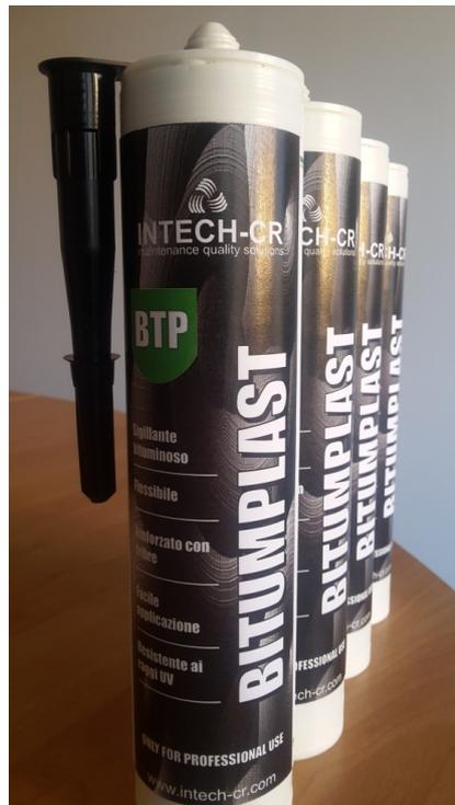
Il **BITUMPLAST** è un sigillante monocomponente bituminoso, esente da solventi, rinforzato con fibre di vetro e gomma butilica. Le sue caratteristiche principali sono: altamente elastico, non corrosivo, sovraverniciabile, ottima resistenza all'invecchiamento, all'esposizione atmosferica e ai raggi UV, ottima adesione su un'ampia gamma di substrati. Monocomponente di facile estrusione con normali pistole da silicone.
